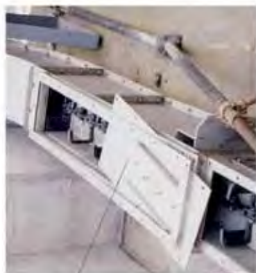
Behälteraustrag mit Zellenrad- schleuse und Schnecken- förderer
